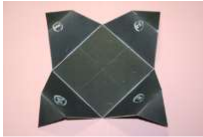
マグネシウム合金の曲げ ピラミッドの曲げ成形
