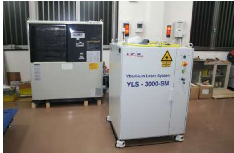
3 kW WSMファイバーレーザ装置 （発振器（右）とチラー（左））
