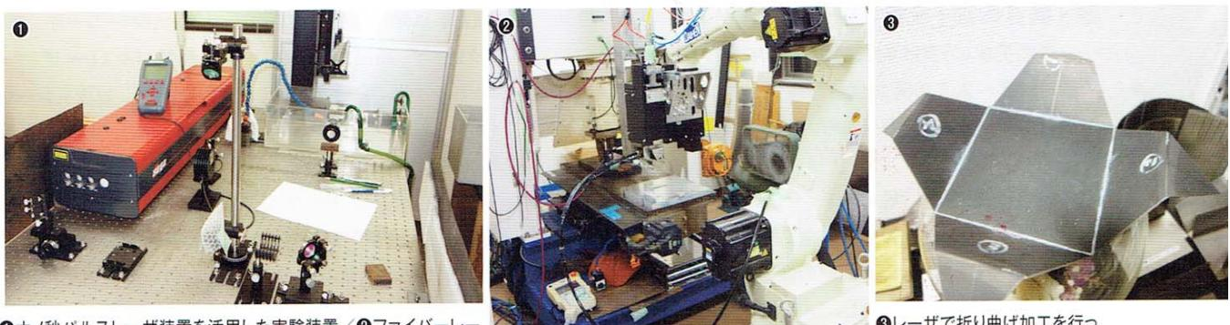
①ナノ秒パルスレーザ装置を活用した実験装置／②ファイバーレーザによるリモート溶接の実験装置
