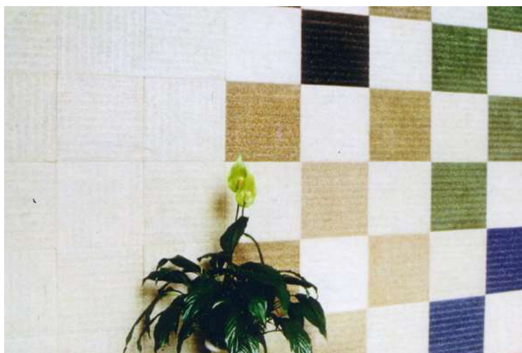
図9レーザ表面溶融で着色したセメント質材 16)
