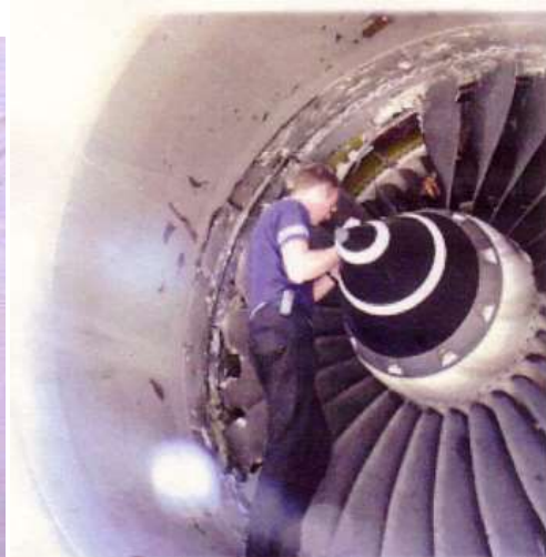
図8 民間機エンジンファンブレードのLP 3)
