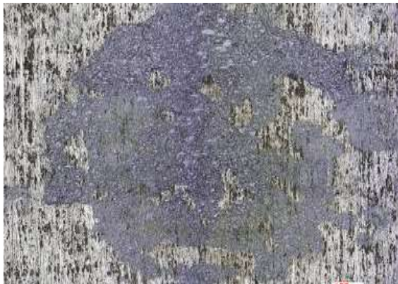
図15 アルミニウム合金製ピストン表面に形成されたディンプルの例
