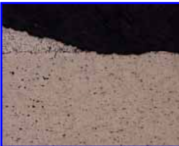
図 1 3 1 千万回後の試験片断面写真
