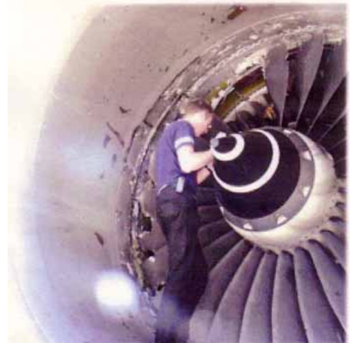
図8 民間機エンジンファンブレードに適用されるレーザピーニング 14)
