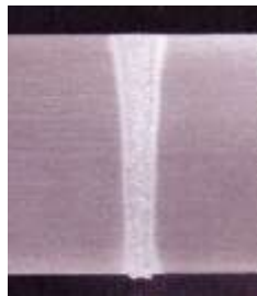
図 2.4.10 X70 鋼管のファイバーレーザー溶接 7)
