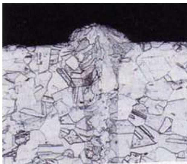
図31 ステンレス鋼の高速溶接(100WCW ファイバーレーザ, v = 40m/min, 溶込み : 320 μm) [30]
