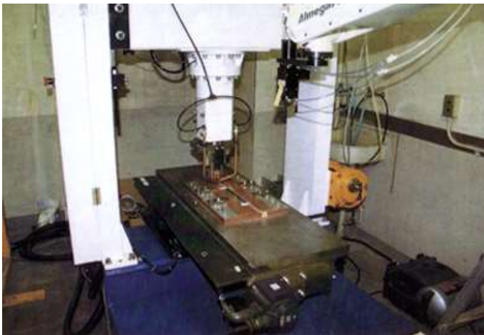
図3 3 異種金属継手用レーザロール溶接システム[33]
