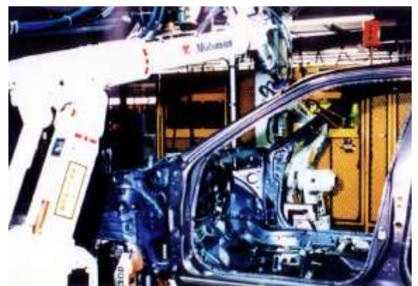
図 1 6 YAG レーザによるアンテナ穴のオンライン穴あけシステム[15]
