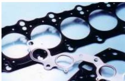
図 1 9 メタルガスケットの YAG レーザ溶接例[18]
