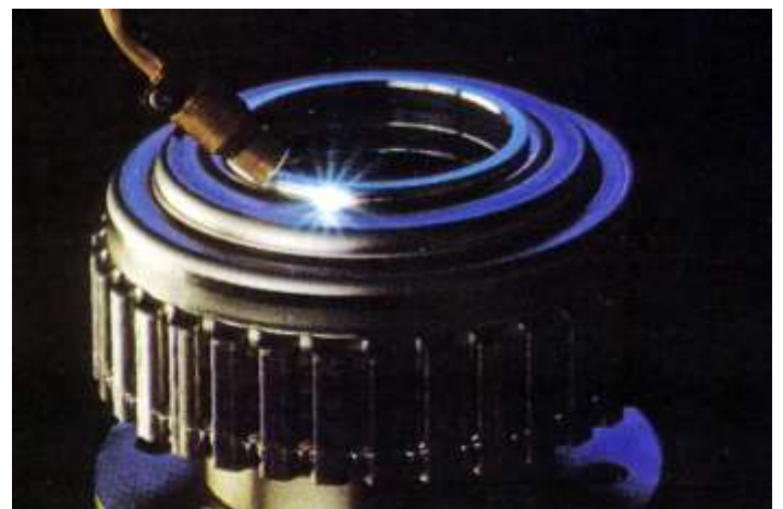
図5 ミッションギヤのレーザ溶接[4]
