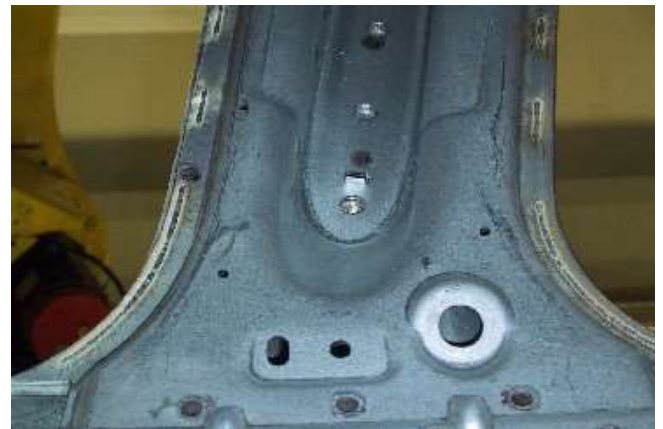
図36 車体パネル重ね継手のレーザースティッチ溶接とピラーへの適用例[34]
