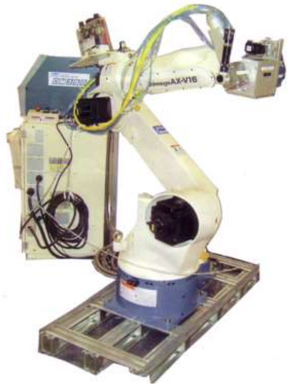
図3 2 3次元リモートレーザ加工用 ALIMS ロボット[32]
