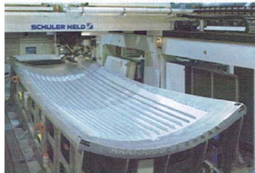
Fig. 25 航空機のスキンプレートとスティフナーのレーザ溶接状況 38)
