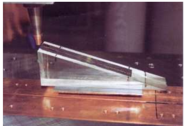
図4 レーザビームの焦点位置測定用治具（アクリル製）
