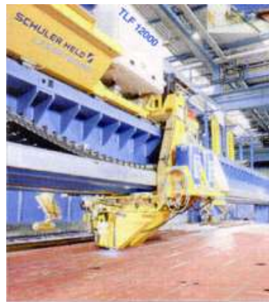
図15 造船用フラットパネルへのハイブリッド溶接の適用状況
