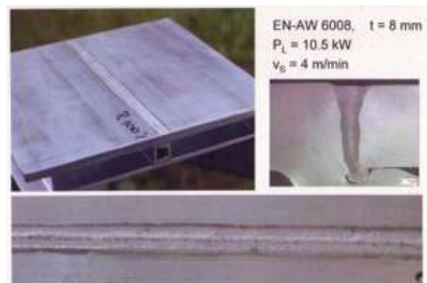
図 27 厚板アルミニウムのハイブリッド溶接
