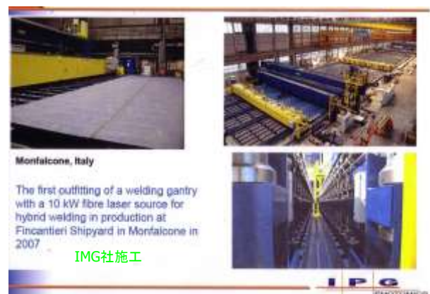
図16 Fincantieri社に導入された10kWファイバーレーザによる溶接システム 73)
