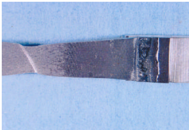
図14 LR溶接継手の引張試験結果
