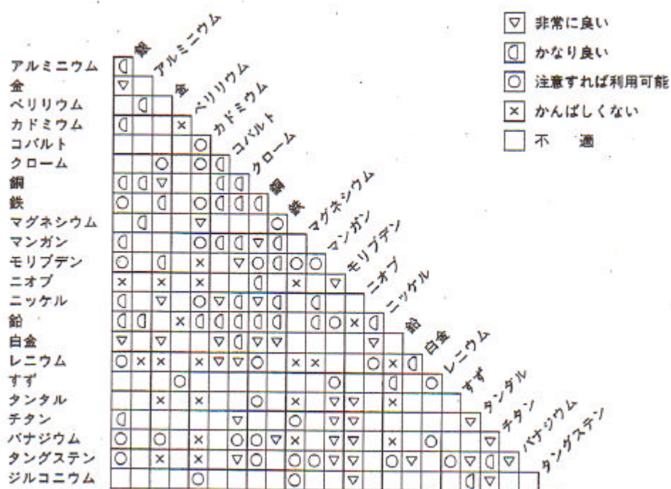
図1 各種金属間の溶接適合性[1]
