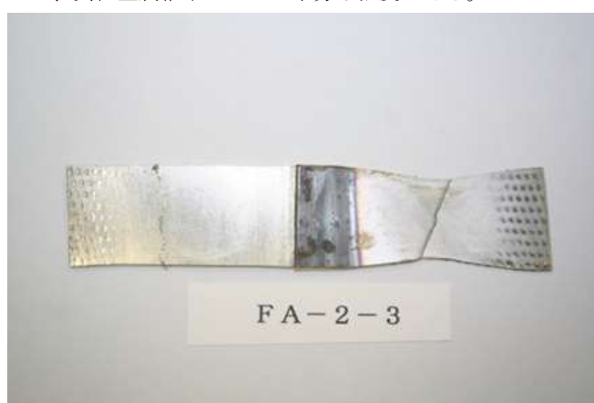
図14 継手引張試験後のレーザロール溶接継手 (母材破断。破断強度 330MPa)
