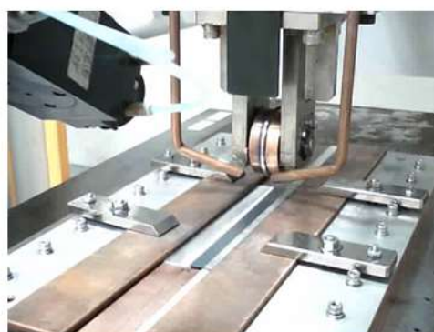
b) レーザーロール溶接装置での溶接状況
