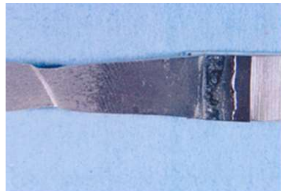
図7 A6061板とSPCC鋼板のレーザーロール溶接継手（SPCC鋼母材で破断）
