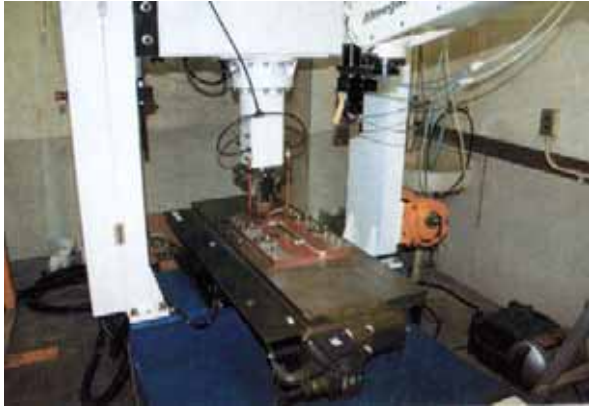
Fig.19 J S T のプロジェクトで開発されたレーザーロール溶接装置
