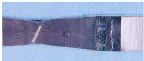
Fig.13 レーザロール溶接継手の引張せん断試験結果
