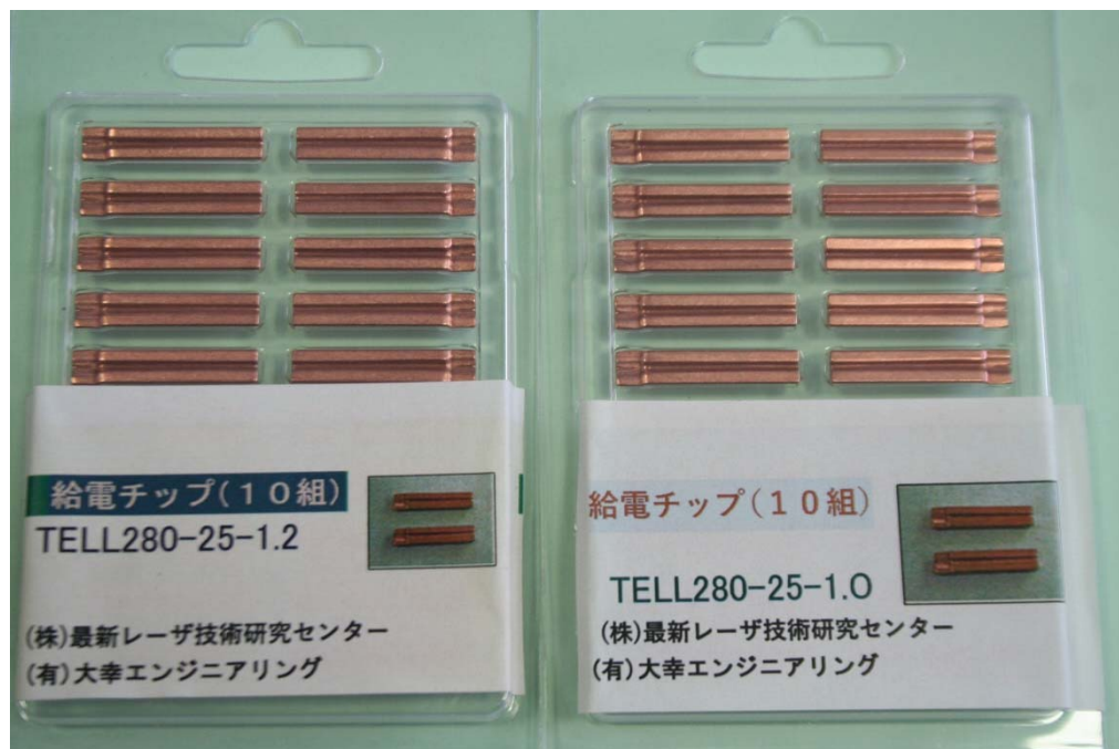
写真1 給電チップ (ワイヤ径 ; 1.2 mm用および1.0 mm用)
