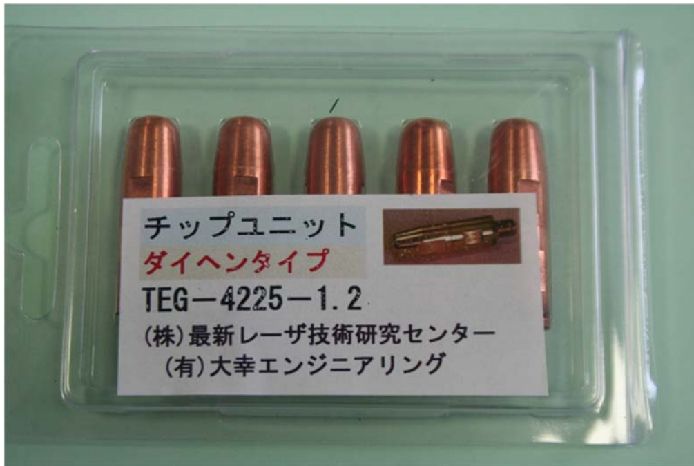
写真 5 チップユニット (=チップカバー+給電チップ+チップベース) ダイヘンタイプ (全長 ; 42 mm、Ext = 40 mm)
