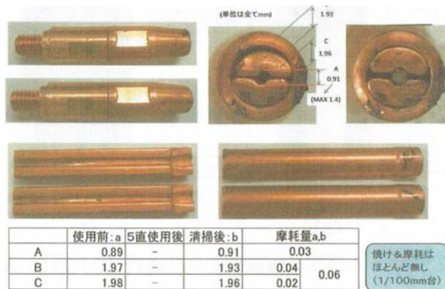
図19 5直使用後の半割れチップの評価値
