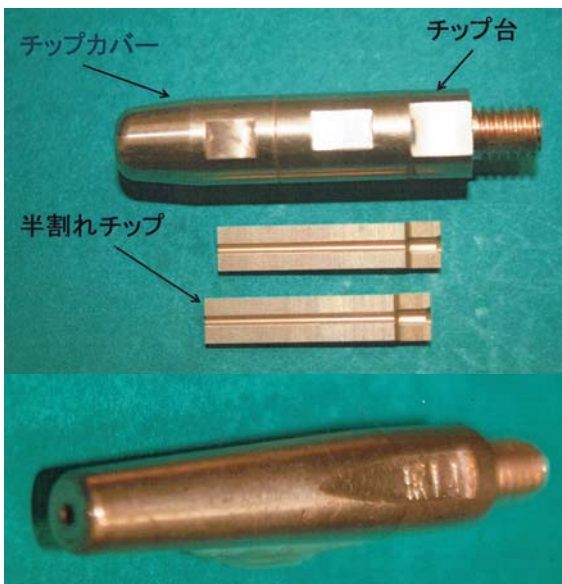
図8 半割れチップとそれを装着したチップユニットの外観 (上) および従来チップ (下) の外観 (一+半割れチップ) として、製品化されている。ここで、チップ台はほぼ1年間以上利用できるもので、
