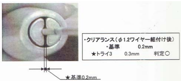
図17 使用前のチップクリアランスの測定
