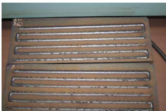
図8 溶接試験片とビード外観
