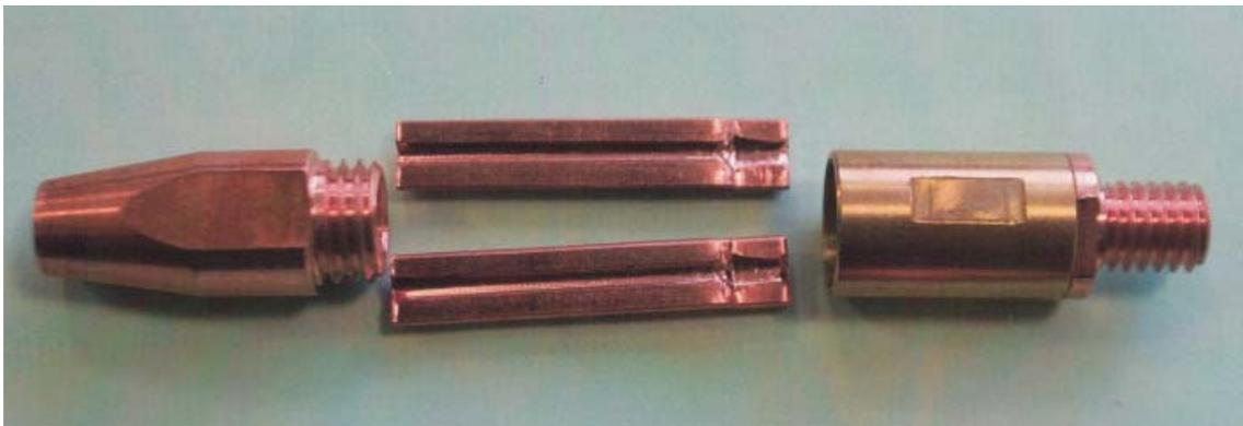
図5 開発したチップユニットの構成（チップカバー（左側）とチップベース（右側））
