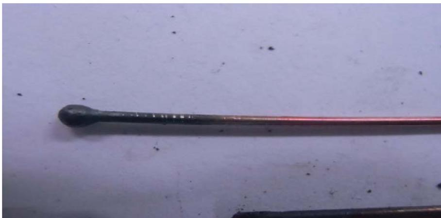
図3 溶接ワイヤの加熱着色領域（チップ先端より左側）
