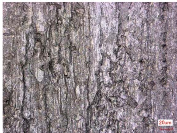
図 1 2 ダイヤモンドカッターによる熱可塑性 CFRP の切断断面の拡大写真
