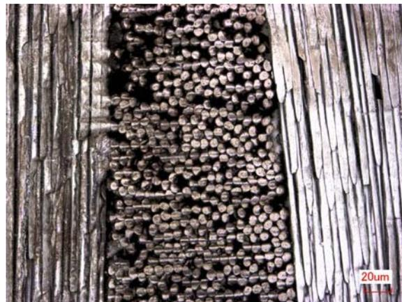
図 1 1 Qスイッチ YAGレーザーによる熱可塑性 CFRP のレーザー加工断面の拡大写真
