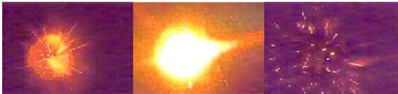
(a) 加熱・蒸発 (b) 蒸発・プラズマ化 (c) 粒子の飛散
