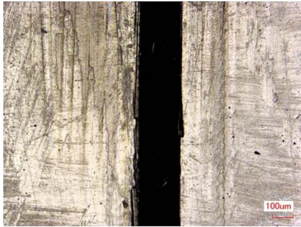
図 1 0 熱可塑性 CFRP の ナノ秒パルスレーザーによる加工外観写真
