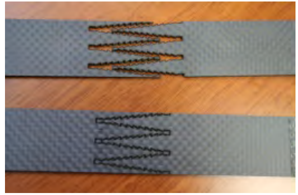
図 1 3 ナノ秒パルスレーザによる開先加工および接着シートで接着した継手 1 1)
