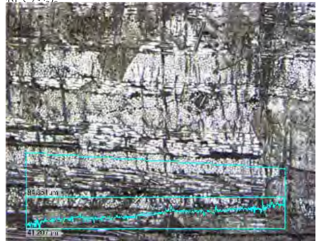
図6 高輝度のシングルモードファイバーレーザによるCFRPの高速切断断面 3)
