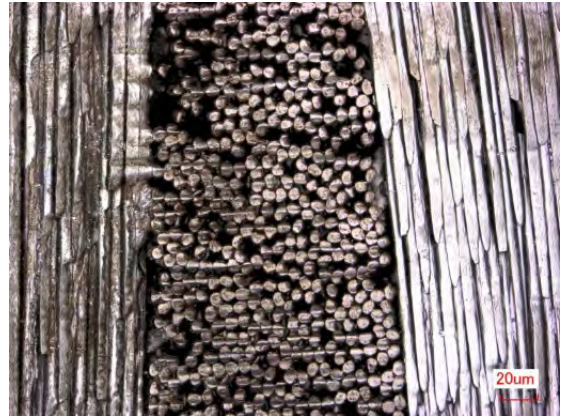
図9 熱可塑性CFRP材のレーザー加工断面写真
