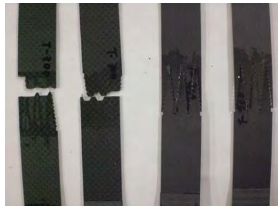
図 1 4 モザイク継手の引張試験後の破断状況（最高継手効率は約 8 0 %）
